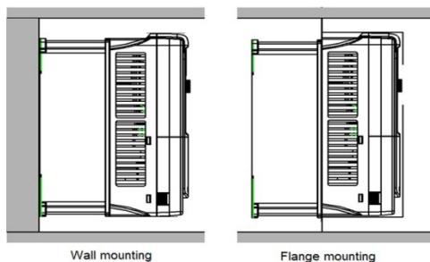
Fig 4-2 Forma de Instalação
