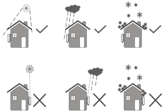
FIG.6-1 Posições de instalação do inversor
