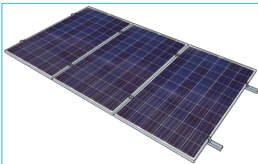
Figura 15 – Exemplo de instalação pelo Frame Longo.
